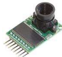
Slika 3. ArduCam Mini 5MP Plus OV5640
